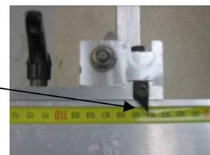
Note : Vérifier l'exactitude et la précision du réglage car le vernier peut être déplacé.
